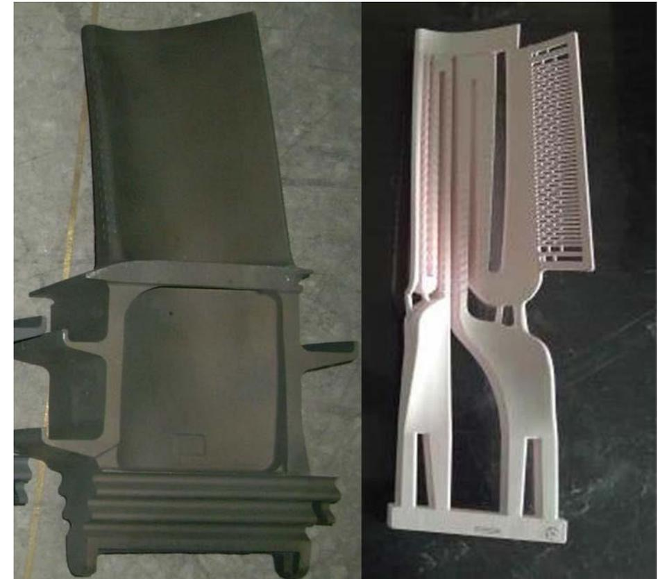
Внешний вид керамического стержня и лопатки первой ступени ГТУ GE 9FA. Сплав GTD111DS
